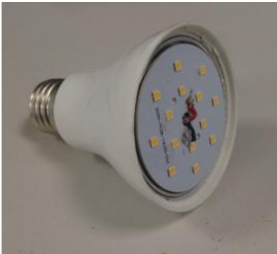
固定灯板及焊线
